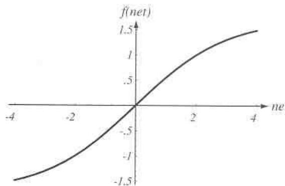
$$g = a \tanh(b \cdot \text{net}) = a \frac{1 - e^{-b \cdot \text{net}}}{1 + e^{-b \cdot \text{net}}} = \frac{2a}{1 + e^{-b \cdot \text{net}}} - a$$
